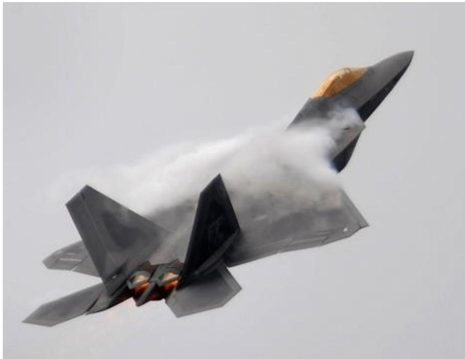
F-22 のエンジンは、上下方向に 20 度まで推力軸を傾ける事ができる推力偏向パドルを採用している。これにより遷音速域で F-15 を上回る旋回性能を持ち、格闘戦性能も高い。
